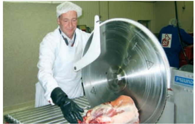
Eiríkur Sigurjónsson frá Hlíð undir Eyjafjöllum sagar ferskt kjöt á nýja hjólahnífum sem skilar hreinum skurði án þess að sag komi í sárið
